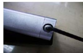
3. 拧下手柄下方的两颗金属螺丝，将自锁组件取下。
