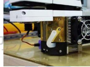
3. 张开叶室，旋松叶室手柄调节螺丝，使手柄与叶室分离，见下左图。用改锥旋松固定叶室上盖和手柄的螺丝（四颗螺丝），下右图。
