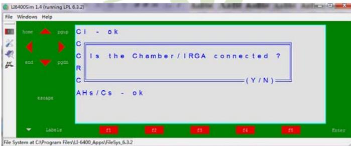
若没有安装其他叶室，则开机后系统直接提示“Is the Chamber/IRGA connected? (Y/N)”，选择 Y，到主界面，见下图，预热 15~20 分钟。
