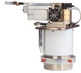
10) 把6400-13热电偶转换器安装到6400主机的辅助口（图10a）上；然后把土壤温度探针连接到转换口（位置见图10b和10c）上。
