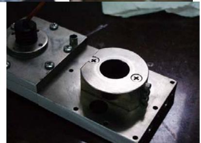
10. 安装手柄螺丝时，要注意右边螺丝还要固定红蓝光源，不要忘拧。记录键插头位于右边，内置光量子传感器的插头位于左侧，如图所示。
